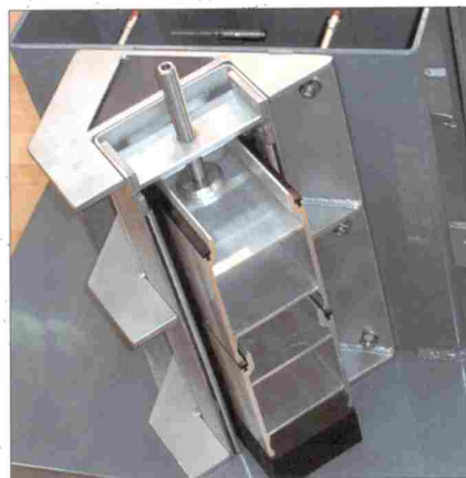
Montaż boczny za pomocą dybli, obciążenie tylko pod wpływem parcia wody na obiekt. Profile-słupy końcowe mocowane są bokiem do ściany obiektu przy pomocy kotwy rozporowej. Do mocowania można też użyć kotwy zespolonej.
