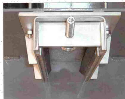
Montaż pod kątem rozwartym w korycie za pomocą dybli przy dużych wysokościach piętrzących. Profile-słupy końcowe mocowane są przy pomocy kotwy rozporowej pod kątem rozwartym w ościeży. Do mocowania można też użyć kotwy zespolonej. Profile – słupy końcowe montuje się bezpośrednio do płyty mocowanej z podłożem. Między profilem – słupem końcowym a płytą zgodnie z wymogami statycznymi wstawia się blachę węzłową.
