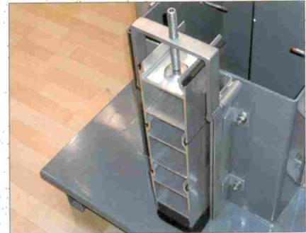
Montaż pod kątem rozwartym w korycie za pomocą dybli. Profile-słupy końcowe mocowane są przy pomocy kotwy rozporowej pod kątem rozwartym w ościeży. Do mocowania można też użyć kotwy zespolonej. Rama na zdjęciu przedstawiona jest wraz ze specjalnym zamocowaniem.
